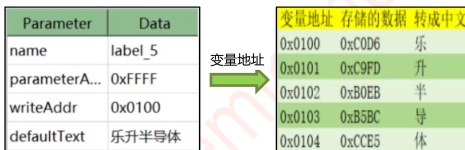
图 7-1: 变量地址内数据的储存方式
