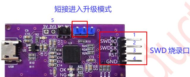
图 1-1：烧录器 PCB 板外观图
