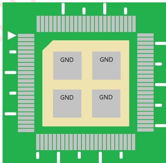
图 8-4: LT7589A 底部焊盘 PCB 的设计建议-2
