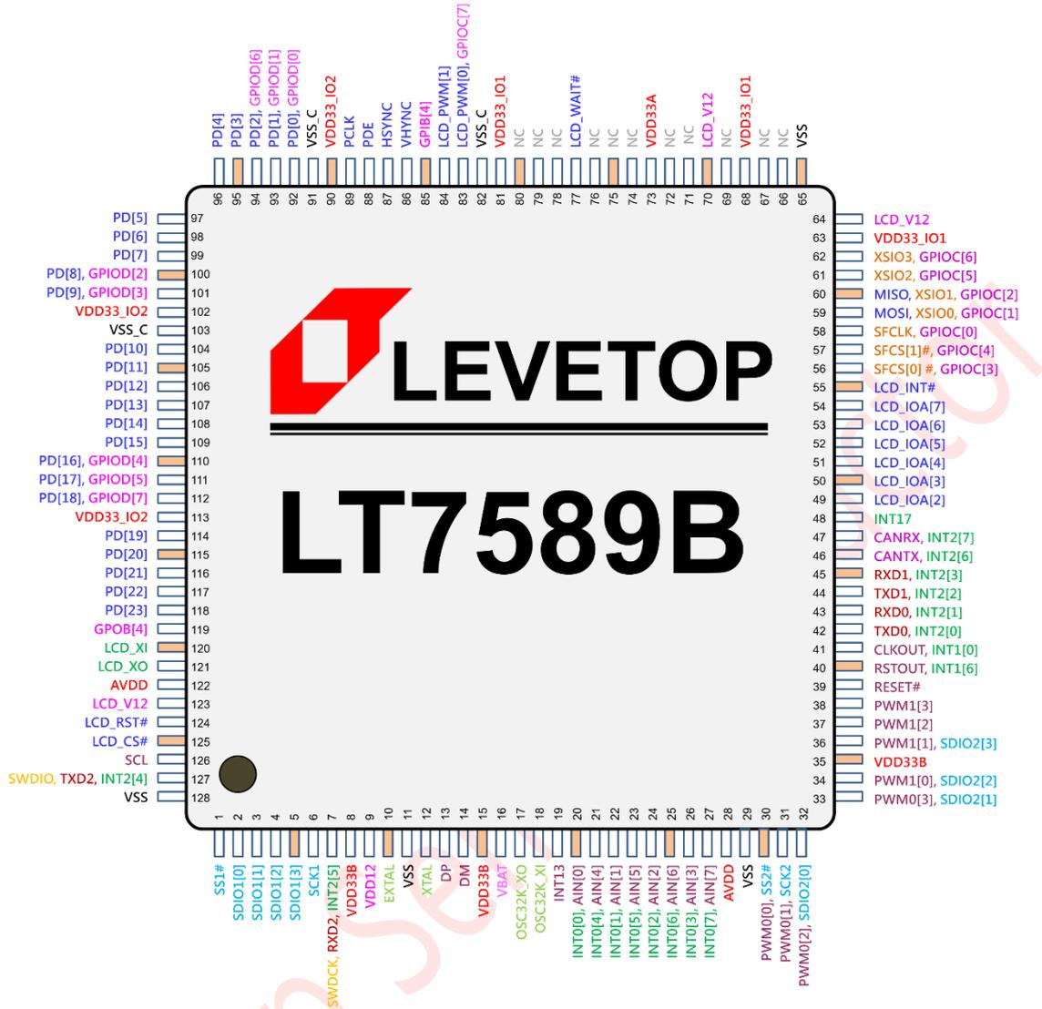
图 5-2: LT7589B 引脚图 (LQFP-128Pin)
