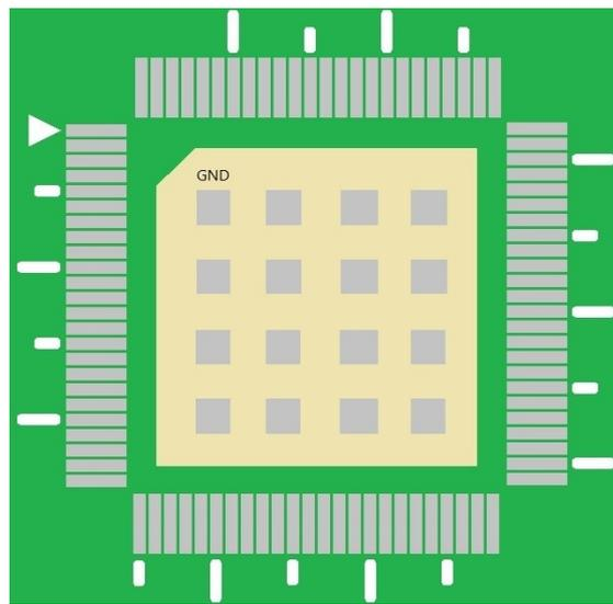
图 8-3: LT7589A 底部焊盘 PCB 的设计建议-1
