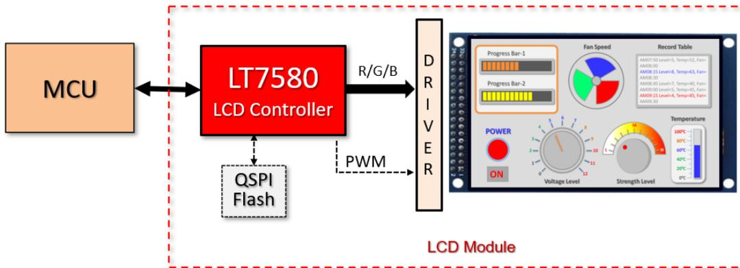
图 1-3: LT7580 设置在 LCD 模块上
