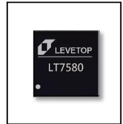
LT7580 与主控端 MCU 连接可以透过 SPI 串口、或是 8 位/16 位的并口界面，芯片内建有 128Mb 的显示内存，可以支持每像素 16bits 的 65K 色或是 24bits 的 16M 色显示，自带 JPG 的硬件解码器、图形显示加速引擎 (BTE) 提供了命令类型的图形操作，如画面镜射、画中画 (PIP) 及图形混合、透明显示等功能，内建的几何绘图引擎则支持画点、画线、画曲线、椭圆、三角形、矩形、圆角矩形等功能，此外 LT7580 提供 QSPI Master 接口，可以外挂 2 个高速 QSPI 元件如 SPI Flash，透过 DMA 模式将存储在 Flash 里面的 UI 显示素材提取到显示内存，能快速地直接将画面显示出来，不需要透过 MCU 进行彩屏数据的传输处理，减轻了 MCU 的软、硬件运行负担，同时提升彩屏显示的效能，而不必为了因为要显示 TFT 彩屏而去升级 MCU。
