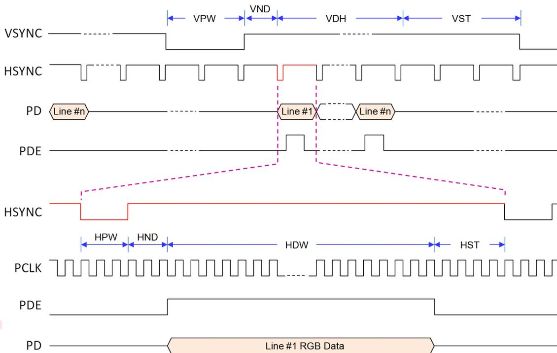
**图 7-1: TFT-LCD RGB 接口时序图**
