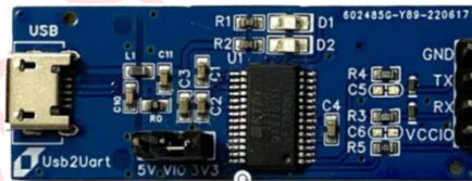
图 2-20: USB 转 TTL 模块
