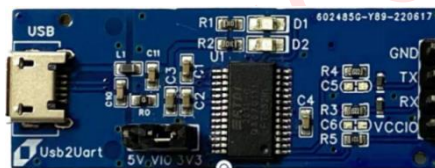
图 2-19: USB 转 TTL 模块
