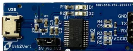
图 2-11: USB 转 TTL 模块
