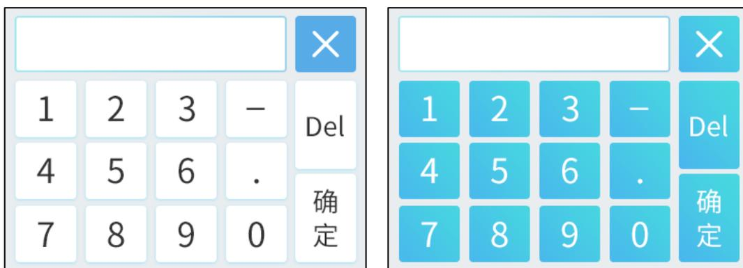
键盘类控件除了底图，还需要字库支持，不同的键盘类控件可选的字库不同，数字键盘和英文键盘的字库编码可选 ASCII、GBK 和 GB2312；中文键盘的字库编码只能选 GBK
