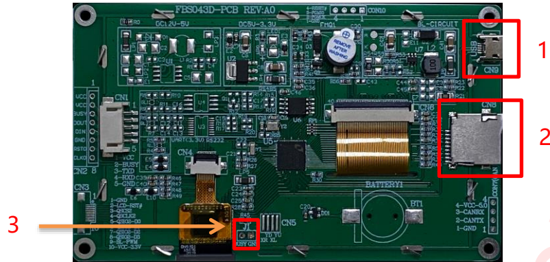
图 2-14: SD 卡更新 UartTFT-II_Flash.bin 示意图
