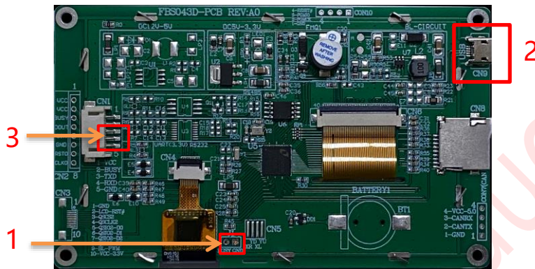
图 2-17: 串口更新 UartTFT-II_Flash.bin 接线示意图
