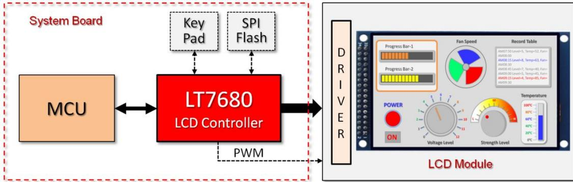
图 1-2: LT7680x-R 设置在系统主板上
