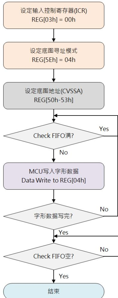
图 13-2: CGRAM 的初始化流程图
