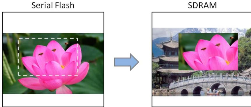
图 15-11：串行闪存的区块模式 DMA 传输
