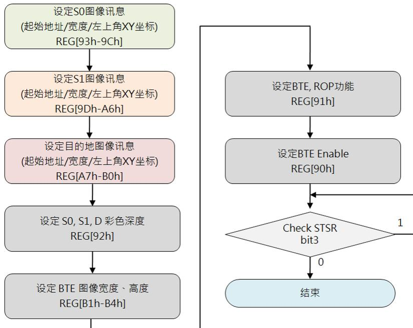
图 12-15: 结合光栅操作的图样填满流程图
