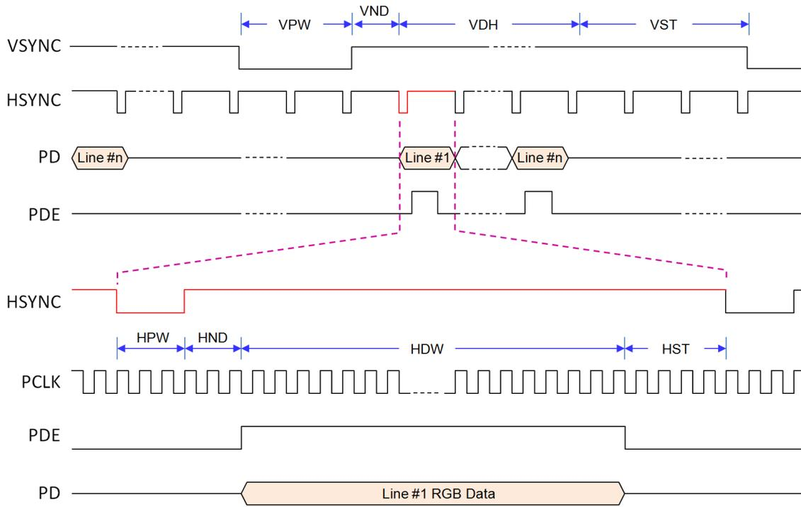
图 9-1: 数字 TFT-LCD 接口时序图
