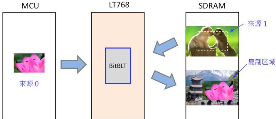
图 12-4: 结合光栅操作的 BTE 写入范例
