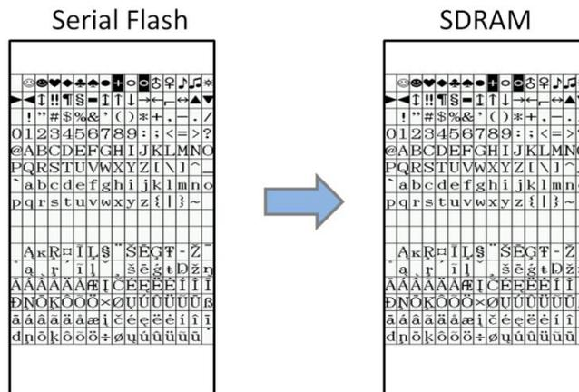
图 15-10: 串行闪存的线性模式 DMA 传输
