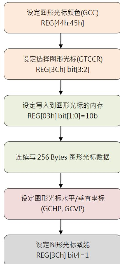
图 13-12：自建图形光标流程图
