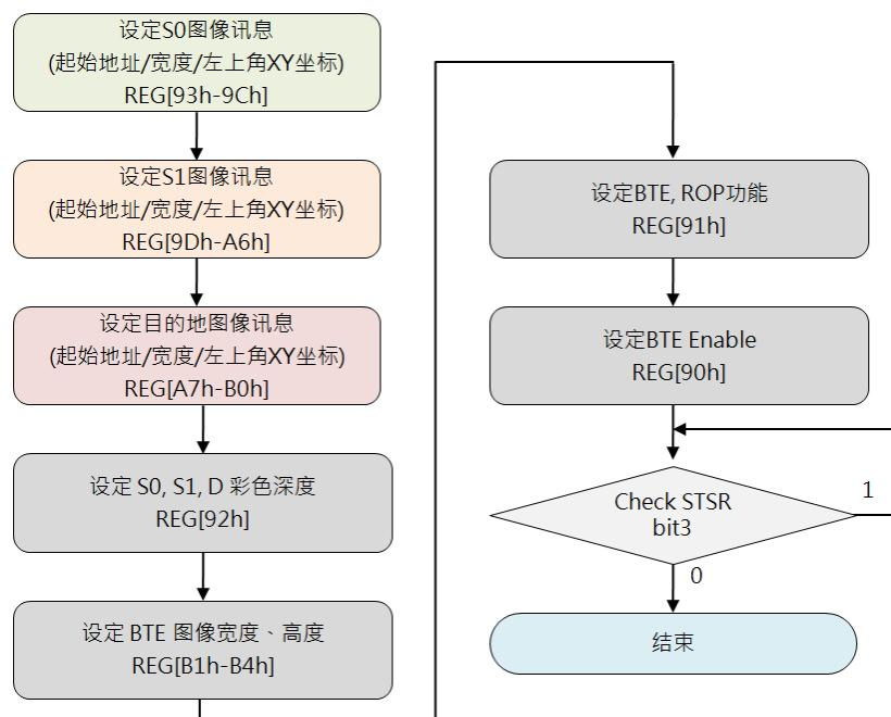
图 12-15：结合光栅操作的图样填满流程图
