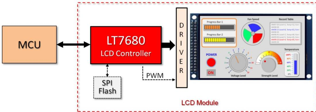
图 1-3: LT7680x-R 设置在 LCD 模块上
