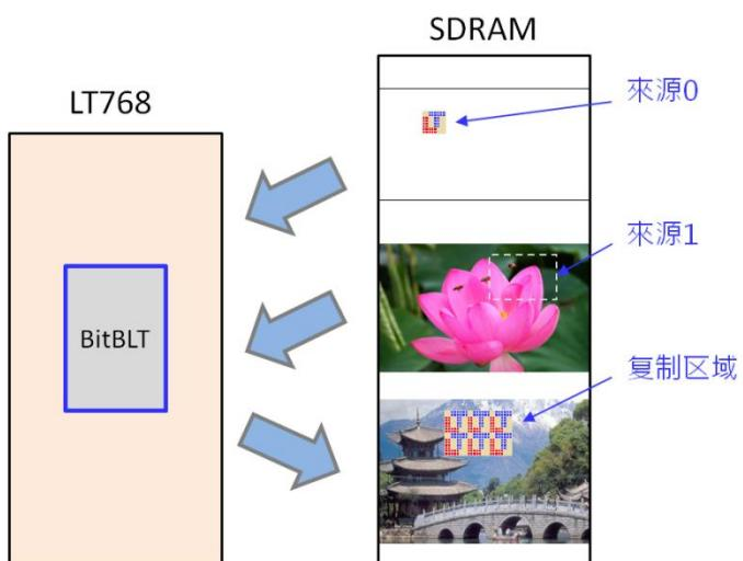
图 12-14：结合光栅操作的图样填满范例
