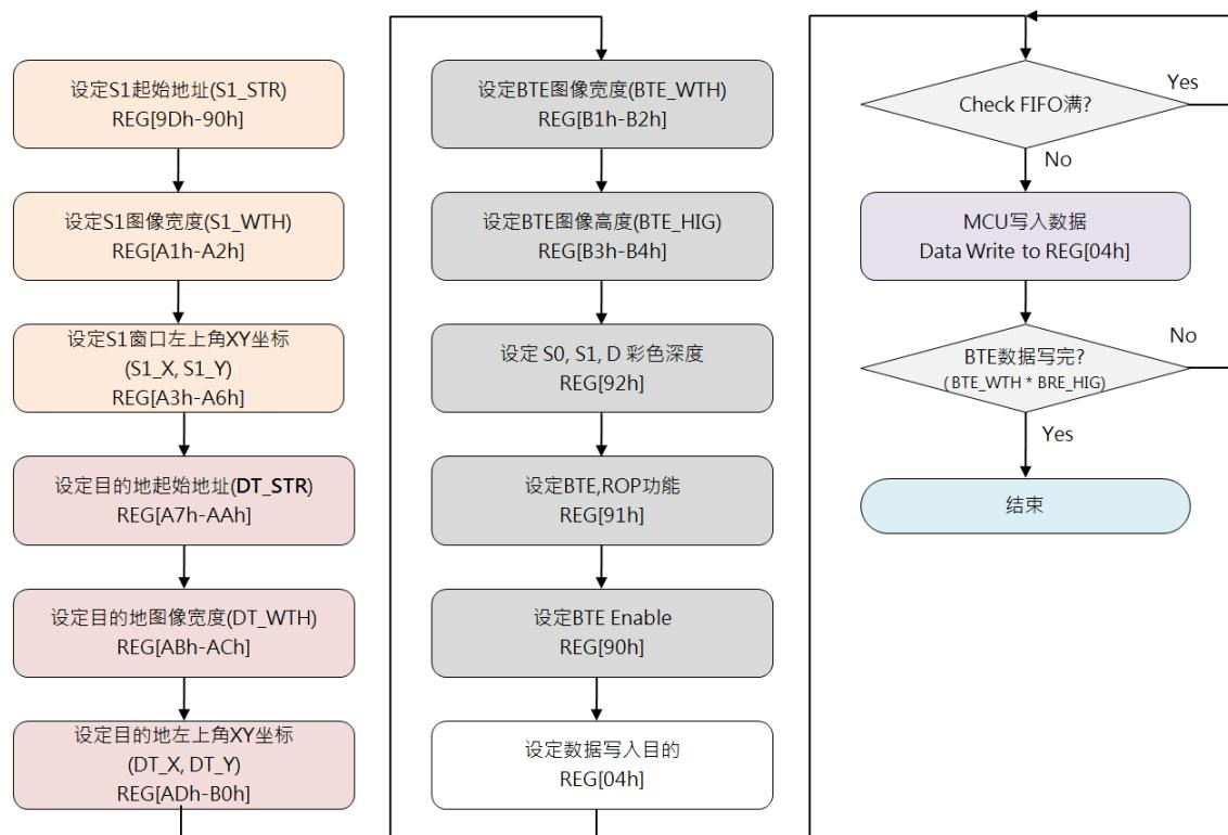
图 12-5：结合光栅操作的 BTE 写入流程图
