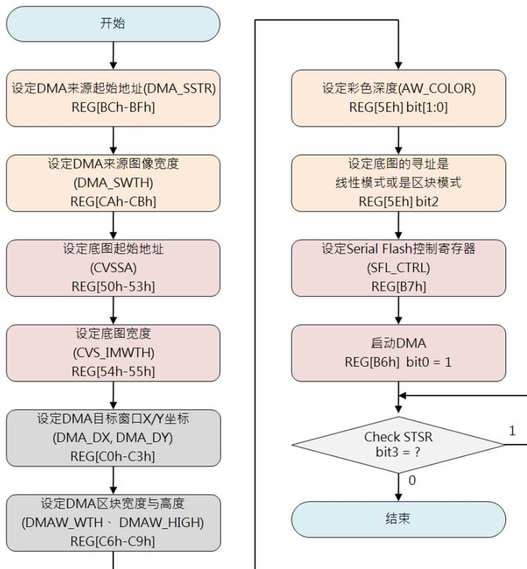
图 15-12：DMA 传输流程图（轮询状态模式）
