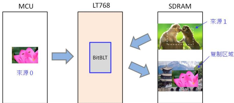
图 12-4：结合光栅操作的 BTE 写入范例
