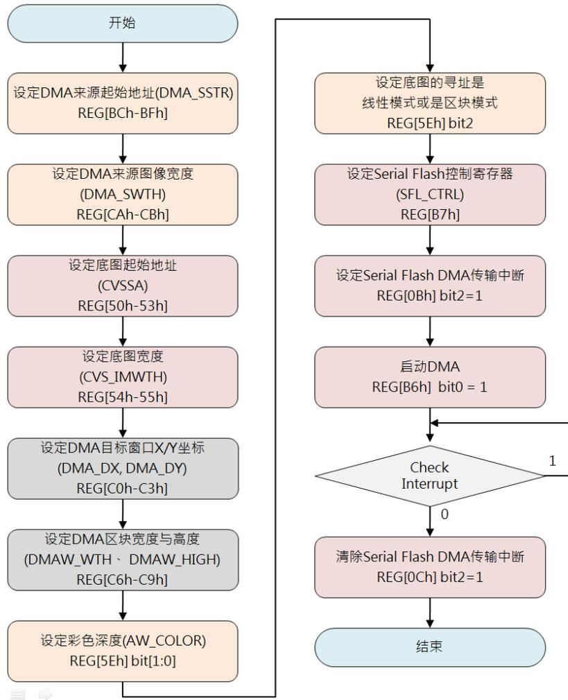
图 15-13: DMA 传输流程图 (使用中断模式)
