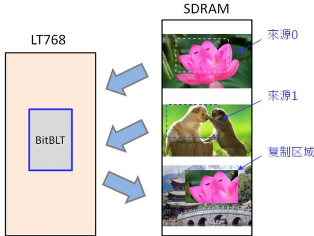
图 12-6: 结合光栅操作的 BTE 内存复制范例
