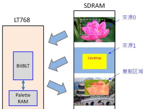
图 12-25: 8bpp Pixel Mode 范例
