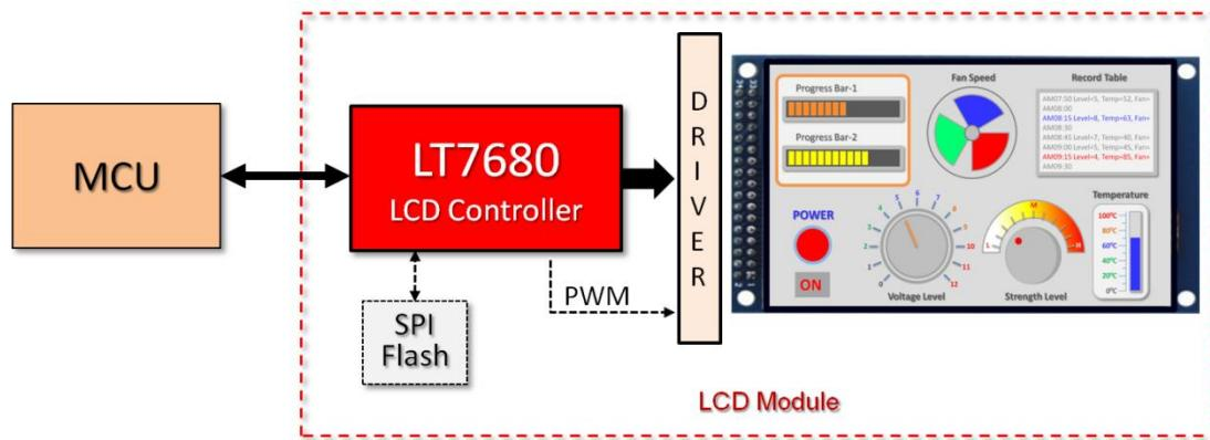
图 1-3: LT7680x-R 设置在 LCD 模块上
