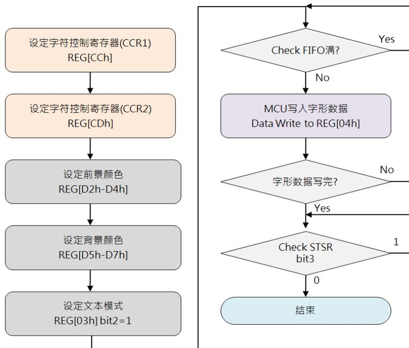
图 13-1A: 使用内建字库流程图
