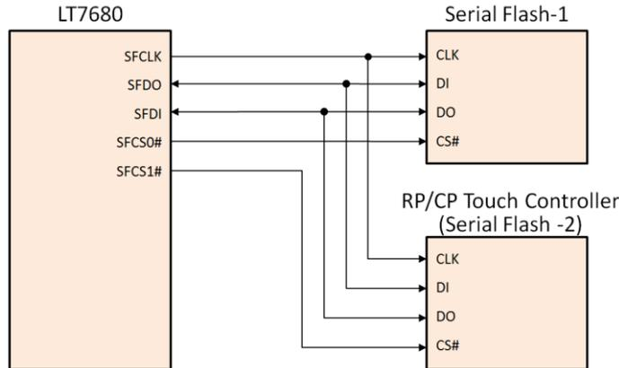
图 15-4: LT7680x-R 串行 Flash/ROM 应用电路
