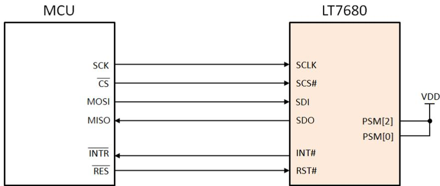
图 7-3: MCU 4 线 SPI 串联接口电路图
