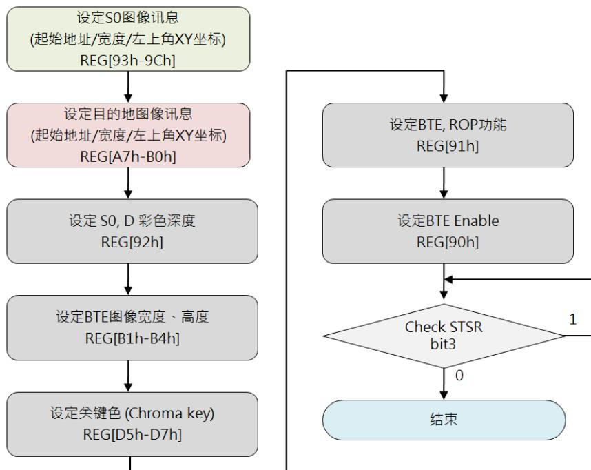
图 12-17：结合 Chroma Key 的图样填满流程图
