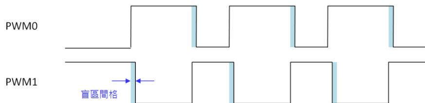
图 14-3：PWM0 和 PWM1 互补输出的盲区时序
