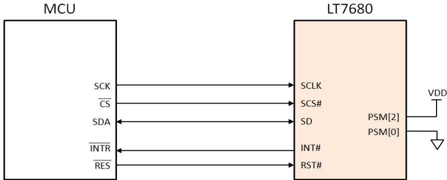
图 7-1: MCU 3 线 SPI 串联接口电路图
