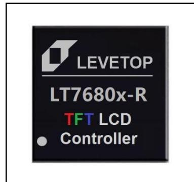
像素 1bit 的 2 灰阶到高达每像素 18bits 的 16M 颜色显示。同时要减少动画显示的 MCU 在软件操作上的负担，LT7680x-R 内建几何绘图引擎，支持画点、画线、画曲线、椭圆、三角形、矩形、圆角矩形等功能，同时内嵌的硬件图形加速引擎 (BTE) 提供了命令类型的图形操作，如显示旋转、画面镜射、画中画 (PIP/子母画面) 及图形混合透明显示等功能，大大提升了产品的显示效能，因而能够极大程度地减轻 MCU 的软件运行负担，如果使用高速的 SPI 接口更能减少 MCU I/O 口的需求，而不必为了 TFT 屏而去升级 MCU。LT7680x-R 强大的显示功能非常适合用在有 TFT-LCD 屏的电子产品上，如家电、多功能事务机、工业设备、工业控制、电子仪器、医疗设备、人机接口、检测设备等产品。
