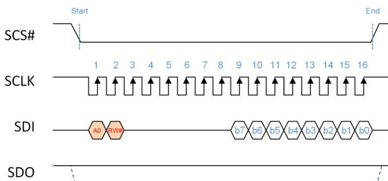
图 7-4: MCU 4 线 SPI 串联界面写入时序图
