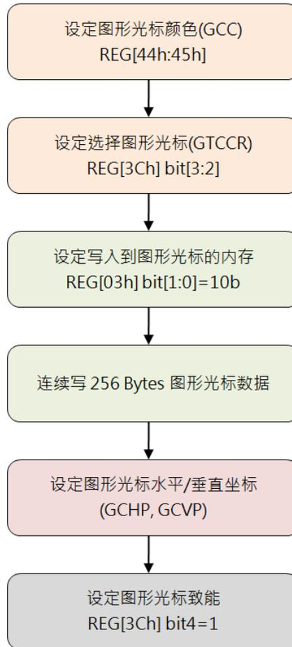
图 13-12: 自建图形光标流程图
