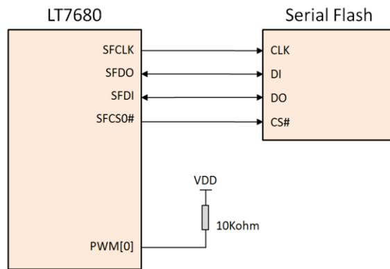
图 15-1: 开机显示功能的设定
