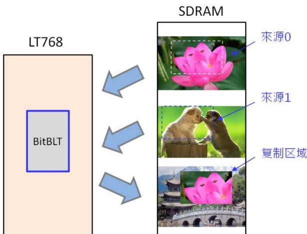
图 12-6：结合光栅操作的 BTE 内存复制范例
