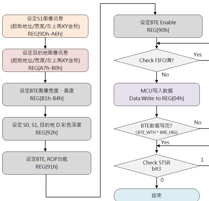
图 12-31：结合透明度的 MCU 写入流程图
