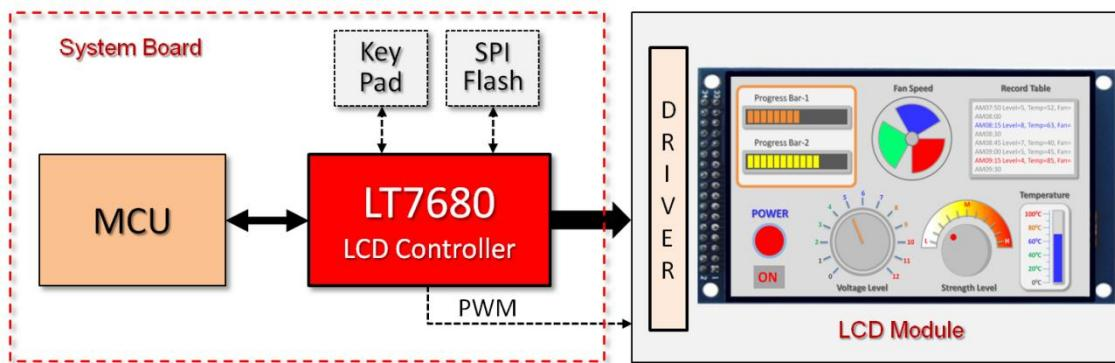
图 1-2: LT7680x-R 设置在系统主板上
