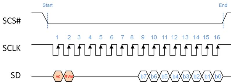
图 7-2: MCU 3 线 SPI 串联界面时序图
