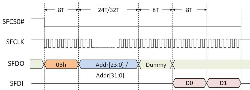
图 15-7: SPI 闪存的快速读取命令
