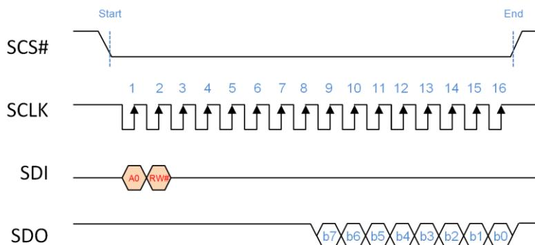
图 7-5：MCU 4 线 SPI 串联接口读取时序图
