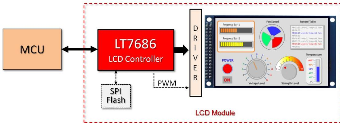
图 A-3: LT7686 设置在 LCD 模块上
