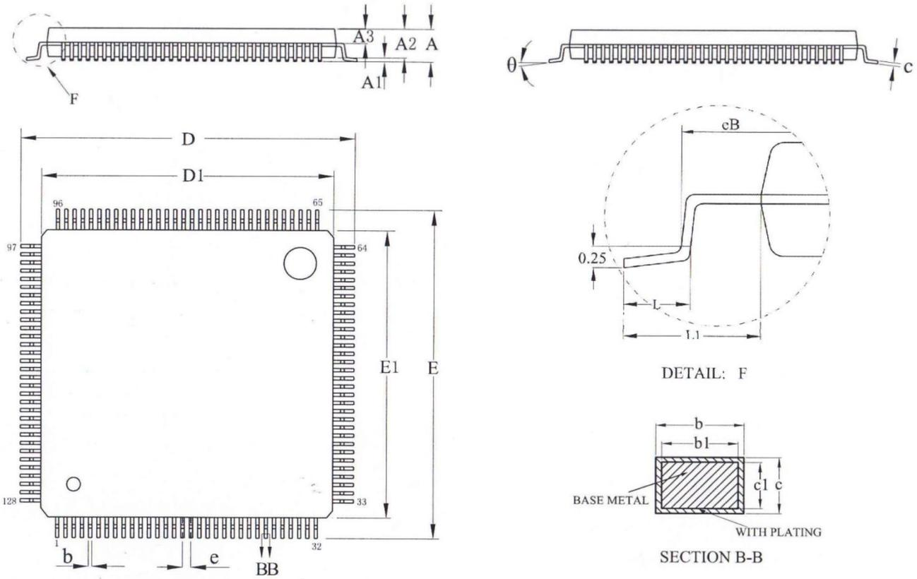
图 B-1: 128Pin LQFP 外观尺寸图
