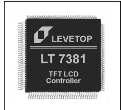
LT7381 支持各种 MCU 接口，包括 SPI、I2C 的串口，或者是 8 位、16 位并行接口。为了达到多层次高分辨率的显示效果，LT7381 内 32Mb 显示内存，可以支持从每像素 1bit 的 2 灰阶到高达每像素 24bits 的 16M 颜色显示。同时要减少动画显示的 MCU 在软件操作上的负担，LT7381 内建几何绘图引擎，支持画点、画线、画曲线、椭圆、三角形、矩形、圆角矩形等功能，同时内嵌的硬件图形加速引擎 (BTE) 提供了命令类型的图形操作，如显示旋转、画面镜射、画中画 (PIP/子母画面) 及图形混合透明显示等功能，能够提升产品的显示效能，如果使用高速的 SPI 接口更能减少 MCU I/O 口的需求。LT7381 的显示功能非常适合用在有 TFT-LCD 屏的电子产品上，如家电、多功能事务机、工业设备、工业控制、电子仪器、医疗设备、人机接口、检测设备等产品。
