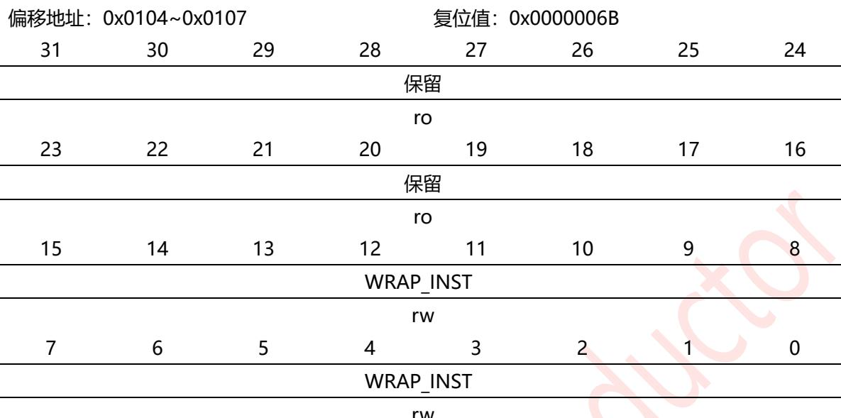
图 9-28: SSI XIP 回环命令寄存器(SSIWIR)
