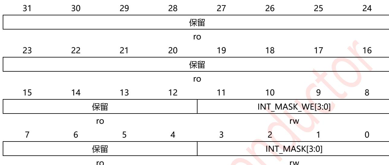
图 22-11: DMAC 中断屏蔽寄存器
