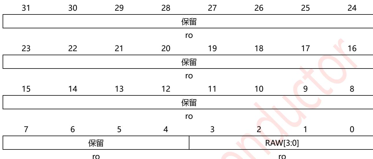
图 22-9: DMAC 中断原始状态寄存器
