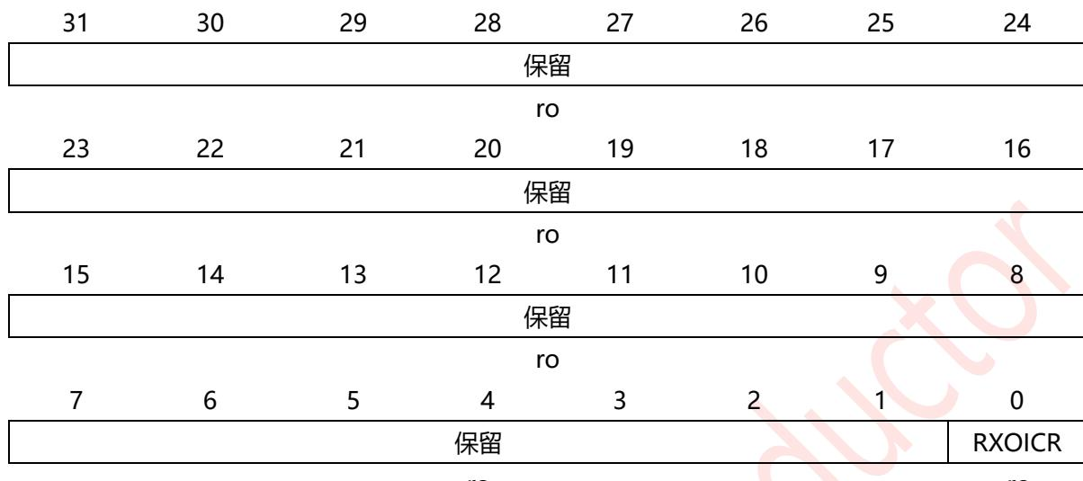
图 9-17: SSI 接收 FIFO 溢出中断清除寄存器(SSIRXOICR)
