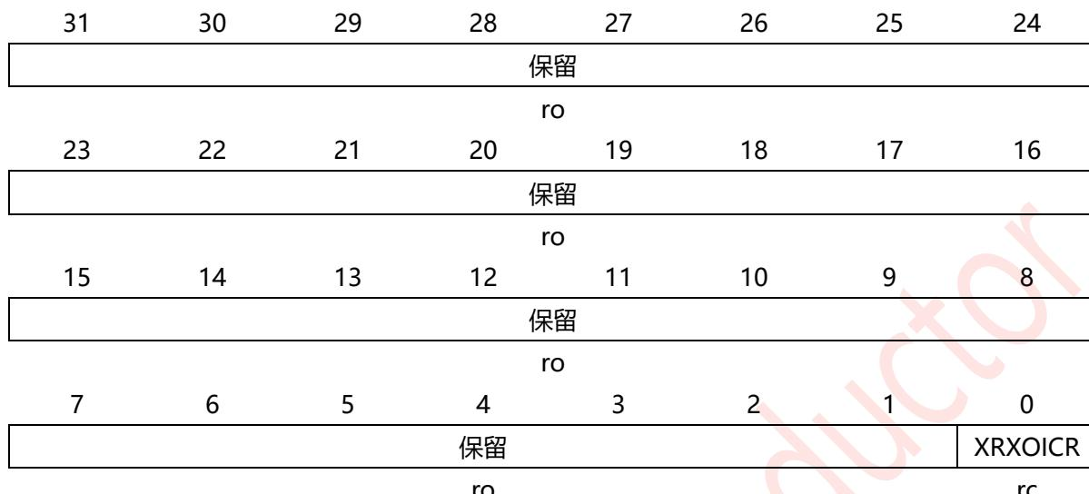
圖 9-31: SSI XIP 接收 FIFO 溢出中断清除寄存器(SSIXRXIOCR)
