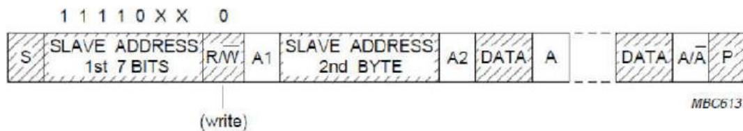
图 12-21：主发送器使用 10 位地址寻址从接收器
