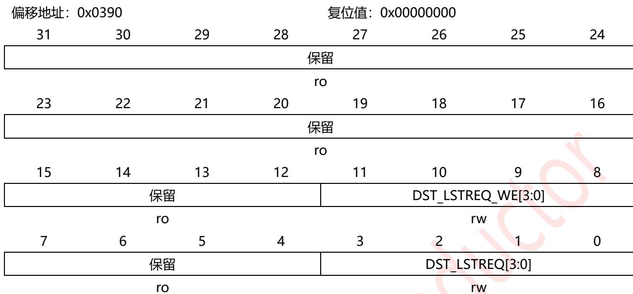
图 22-19: DMAC 软件目的端最后一次传输请求寄存器
