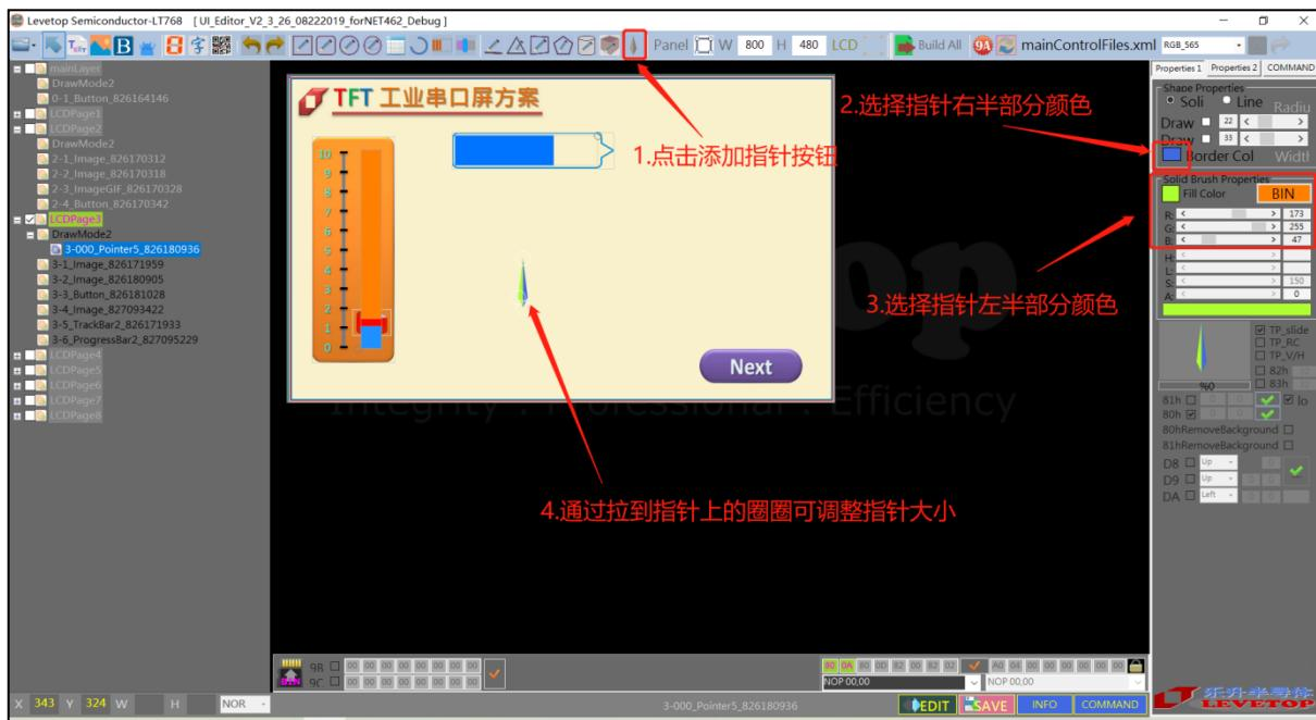
图 3-53：设定指针对左右两侧的背景颜色
