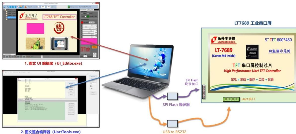
图 1-2：使用上位机软件开发的示意图
