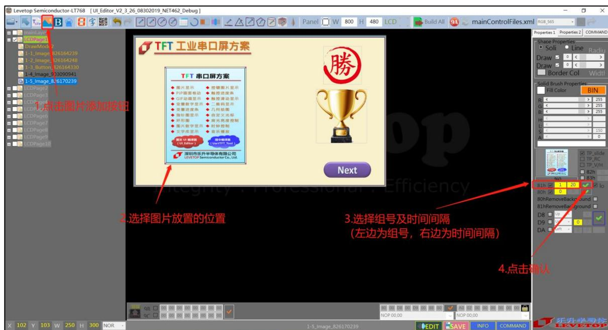
图 3-31：设定循环显示重叠图片
