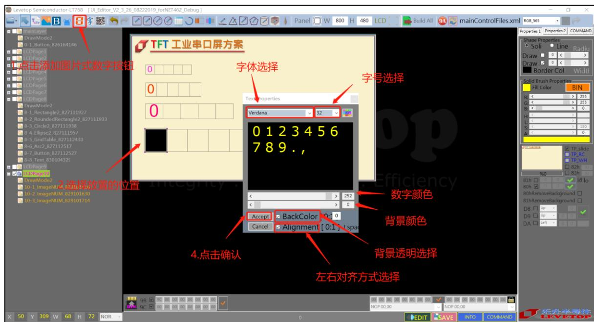
图 3-77：图片式的数字显示的设置窗口
