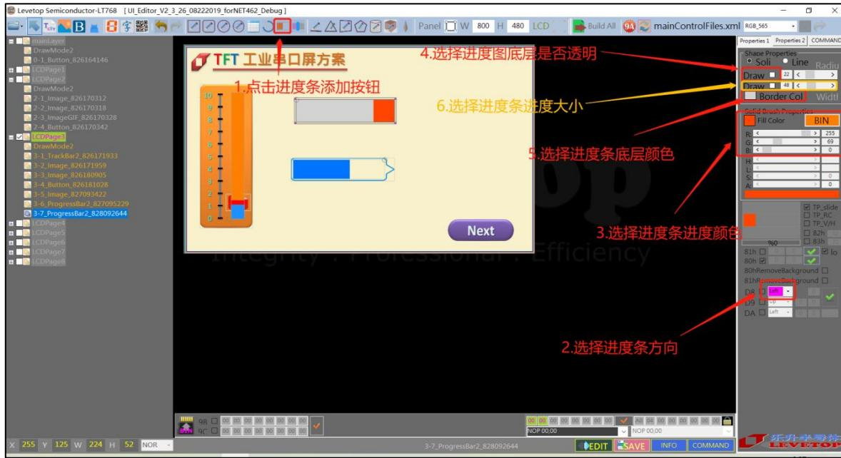
图 3-59：设定进度条背景与进度条移动时的颜色
