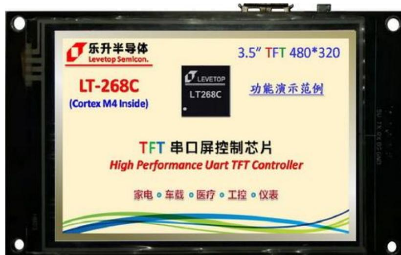
图 1-7: LT268C 串口屏的开发演示板 - 1
