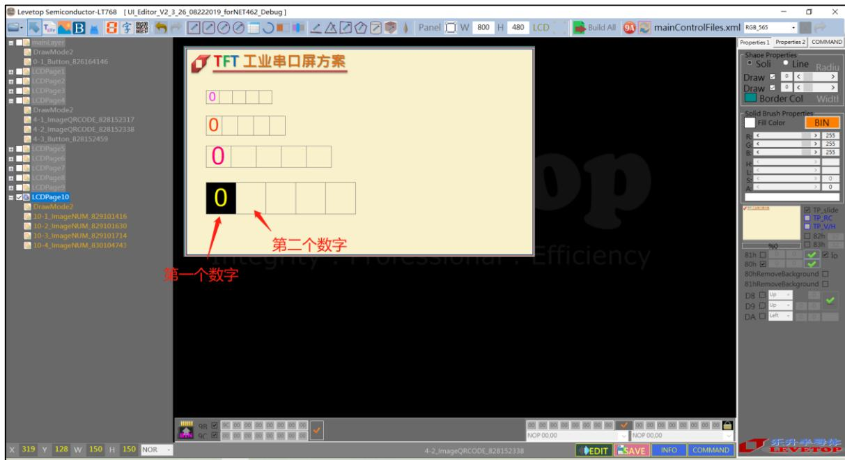
图 3-78：调整图片式数字显示的字体框
