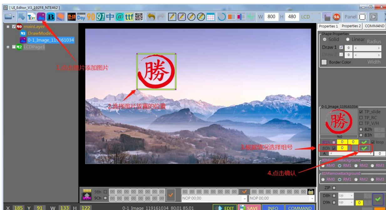
图 3-30：设定显示多张图片
