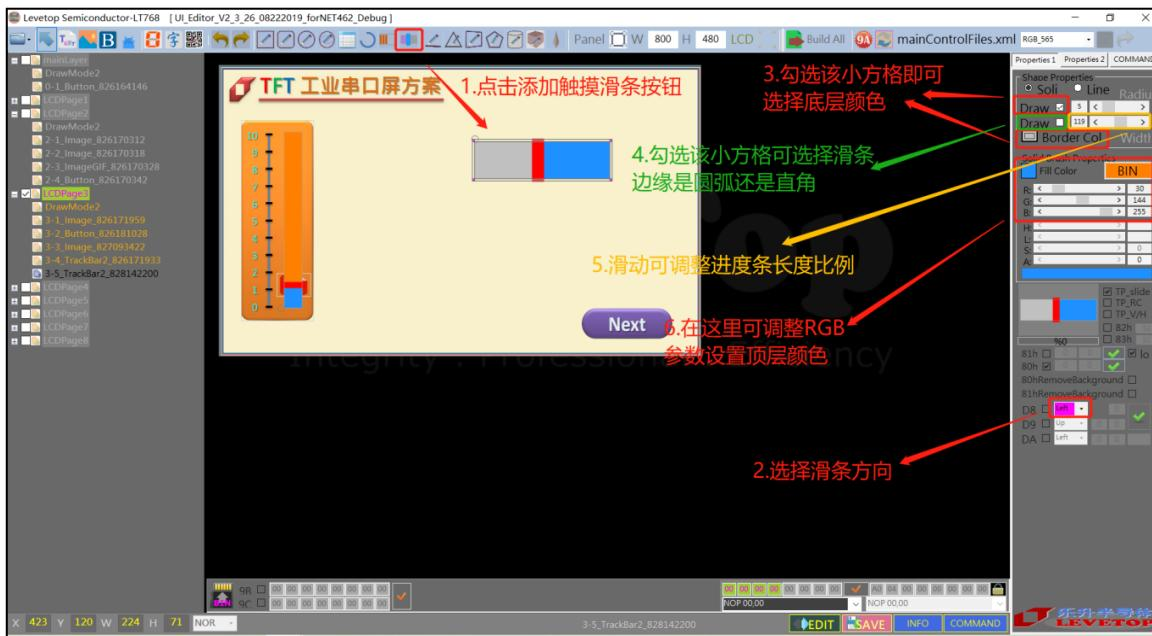
图 3-43：设定滑动条及前景颜色与背景颜色
