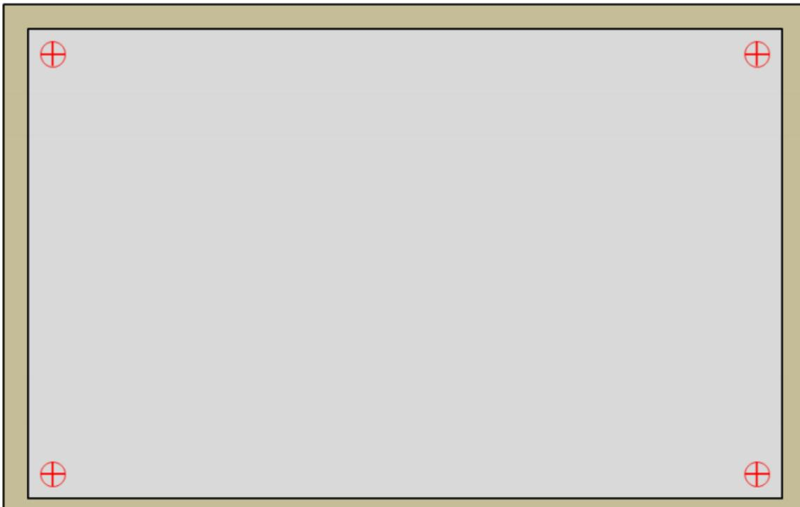
图 3-112：电阻屏的 4 个角落校验
