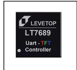
LT7689 内部的 M4 主频可达 150MHz，含有 508KB Flash、256KB SRAM、2D 图形加速显示器、128Mb 显示内存，支持的串口屏指令包括图片显示、GIF 动画显示、循环图片显示、开机画面显示、进度条显示、文字字符串显示、二维码产生、音讯播放，及结合触控功能的效果等，配合 乐升半导体 的串口屏开发软件(UI\_Editor)、模拟软件(UI\_Emulator) 能快速地完成中小尺寸的 TFT 串口屏显示方案。除了串口屏 Uart 通讯接口，LT7689 还提供多组的 SCI (Uart) 接口可以连接如蓝牙模块、WiFi 模块等组件，也提供 USB 接口、SD 卡 (SPI)，可作为音频输出的 DAC 接口，模拟输入 AIN、PWM 及 INT 中断等接口，这些也可以设置成普通 IO 接口，同时自带 RTC 时钟。
