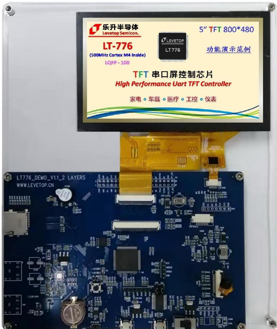
图 2-17: LT776 TFT 串口屏开发板 (Demo Kit)
