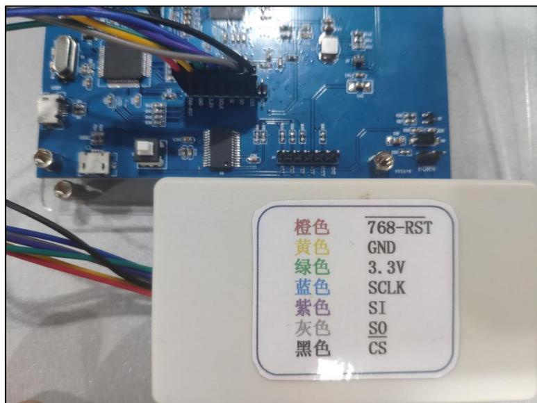
图 4-120: SPI Flash 烧录器与接线方式
