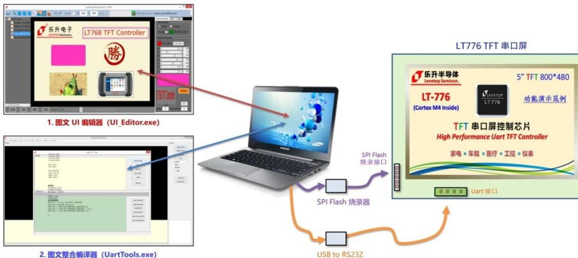
图 1-5: 使用上位机软件开发的示意图
