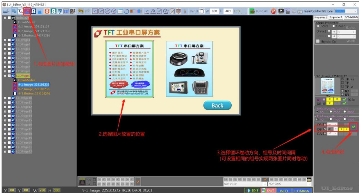
图 4-33：设定循环卷动图片
