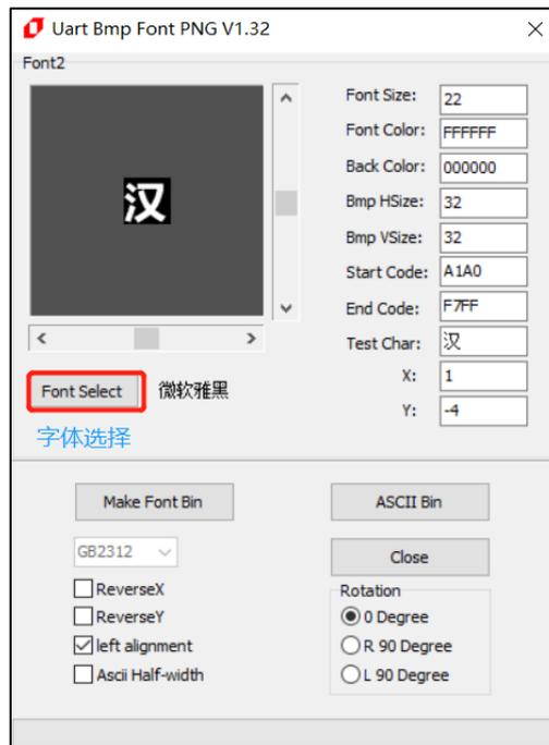
图 5-12：制作 Png ASCII 码文件
