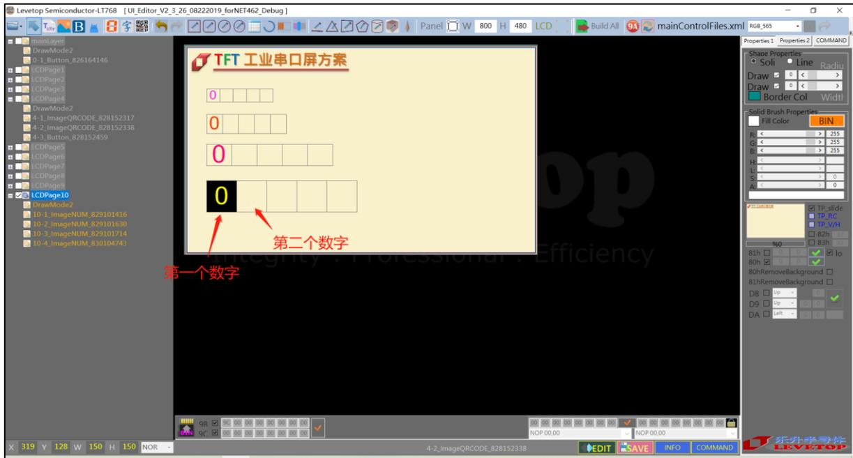
图 4-77：调整图片式数字显示的字体框
