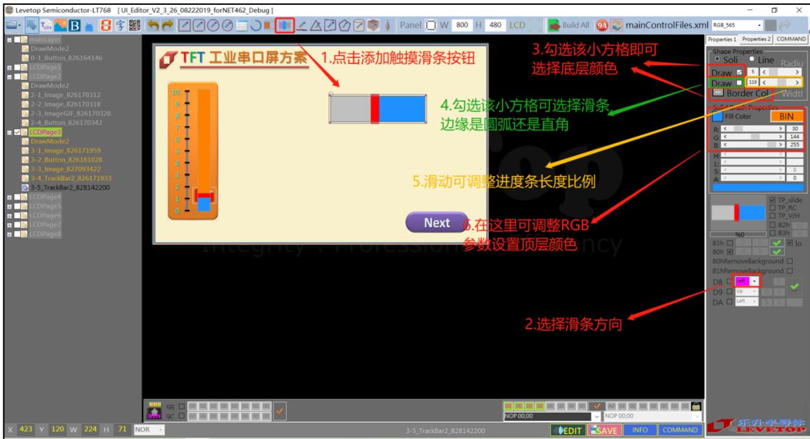
图 3-42：设定滑动条及前景颜色与背景颜色
