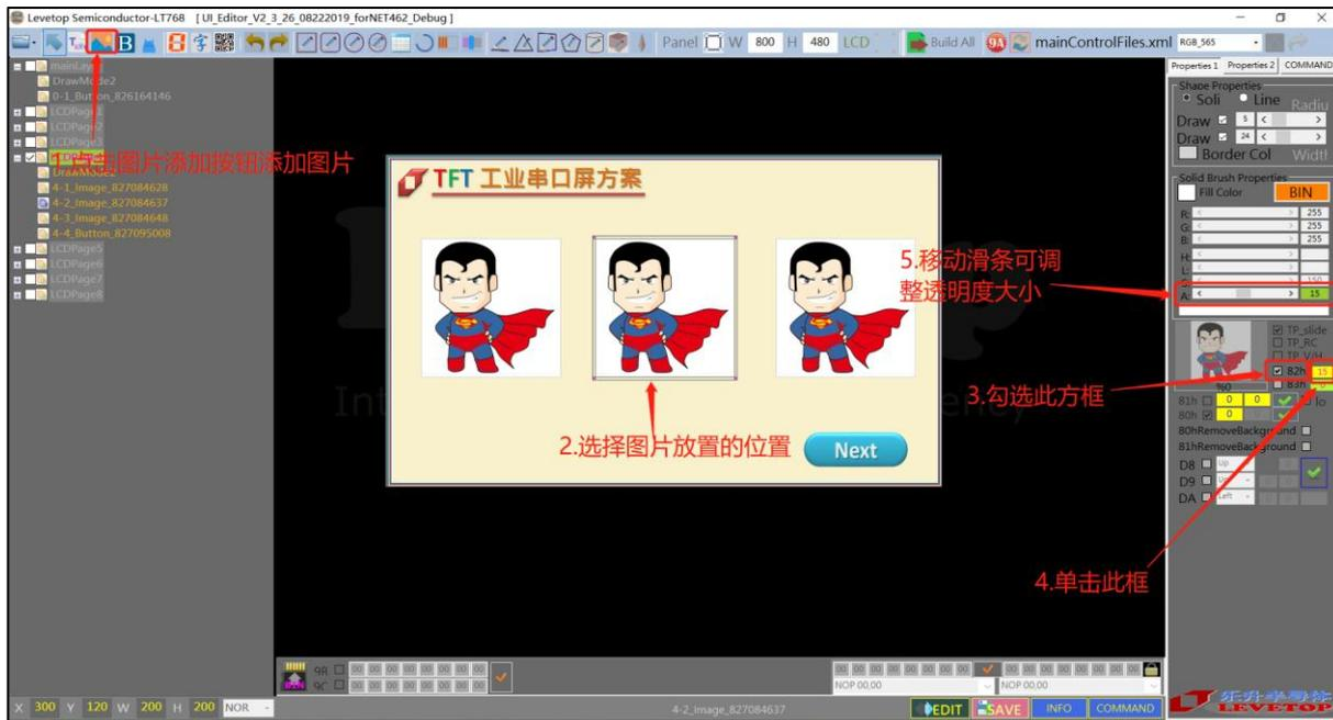
图 3-58：设定带透明度的单张图片
