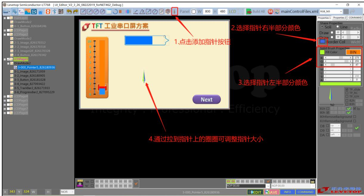
图 3-50：设定指针对左右两侧的背景颜色
