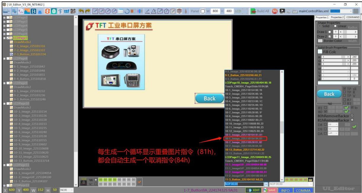
图 3-28: 取消循环显示重叠图片
