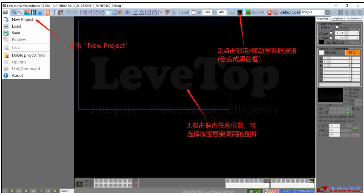
图 3-7B：新建工程方式一
