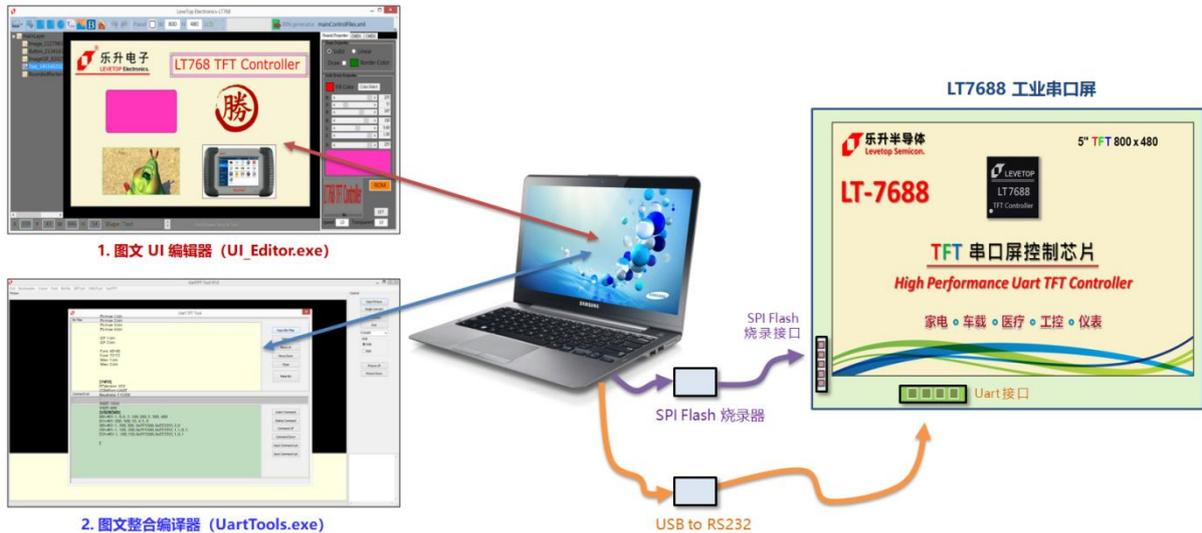
图 1-6: 使用上位机软件开发的示意图
